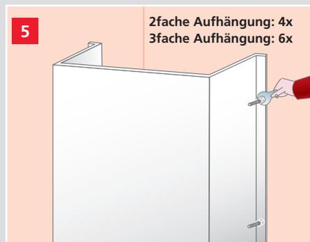
5 Schacht ausrichten und lückenlos an der Wand fixieren. Bitte beachten: Die Muttern sind festigend am Schacht anzuziehen.
