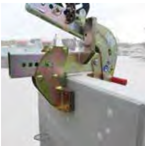
Zange zum Versetzen der Winkelstützen (max. 2 to)
